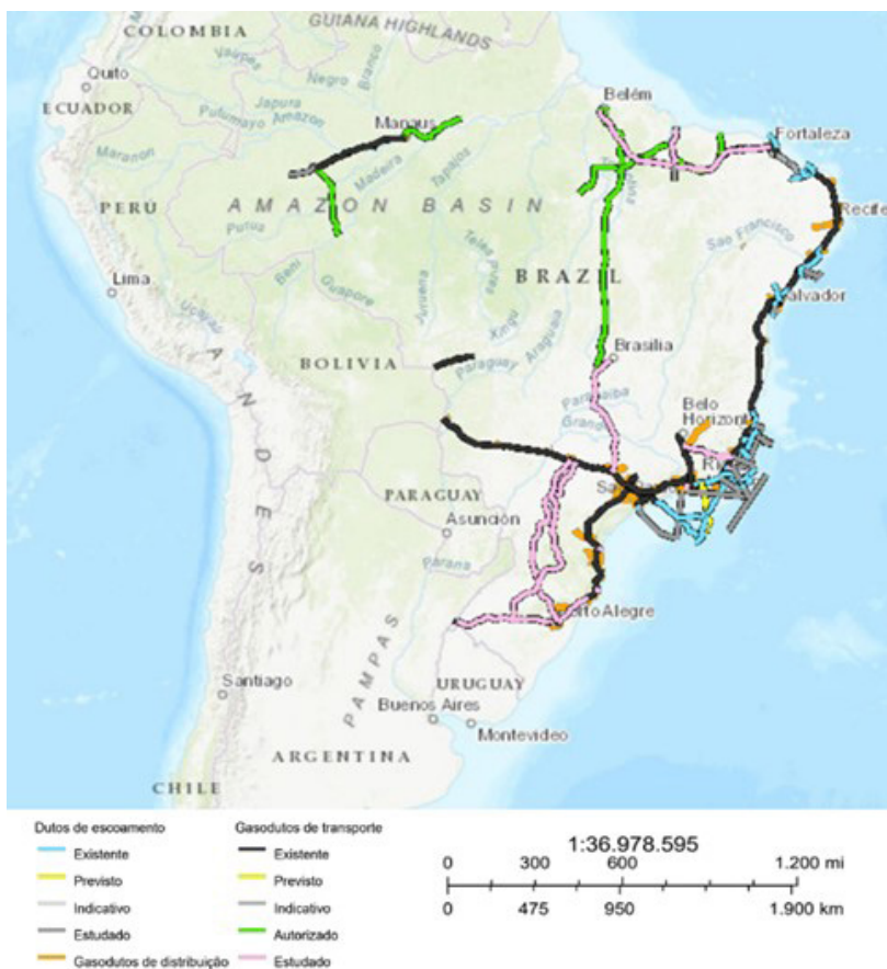
Figura 5.11 - Mapa representando a malha de dutos de escoamento, gasodutos de transporte e de distribuição.
