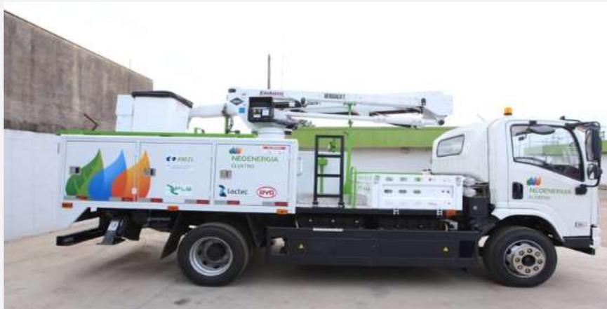
Figura 2: Caminhão elétrico desenvolvido pela Neoenergia.
