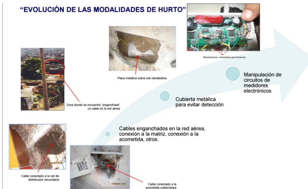
Figura 10– Modalidades de Furto de Energia na Área de Concessão da Luz del Sur.
