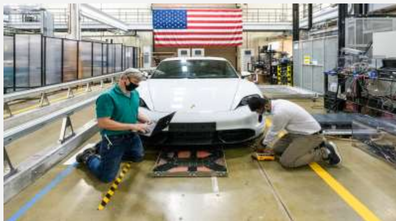
Figura 4 - Bobina eletromagnética polifásica sendo testada em um Porsche Taycan Fonte: ORNL (2021).
