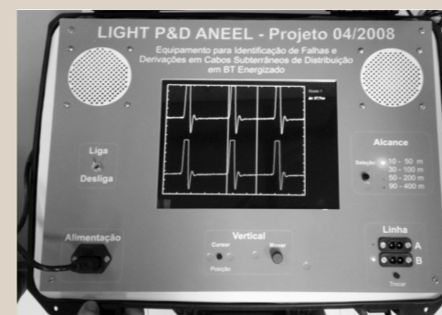
Figura 3 – Foto da tela com a exibição dos dois canais de aquisição e a tampa frontal do equipamento, com os cursores e faixas de operação.
