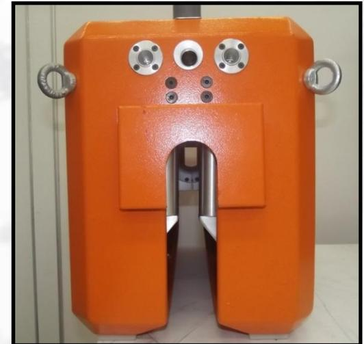
**SISTEMA DE DETECÇÃO DE CORROSÃO PARA CABOS CAA EM LINHA ENERGIZADA**
