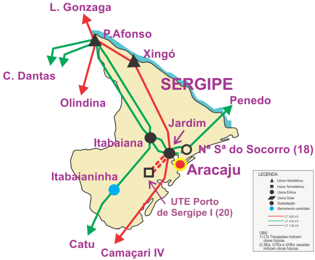
Figura 8-12: Sistema elétrico no estado de Sergipe
