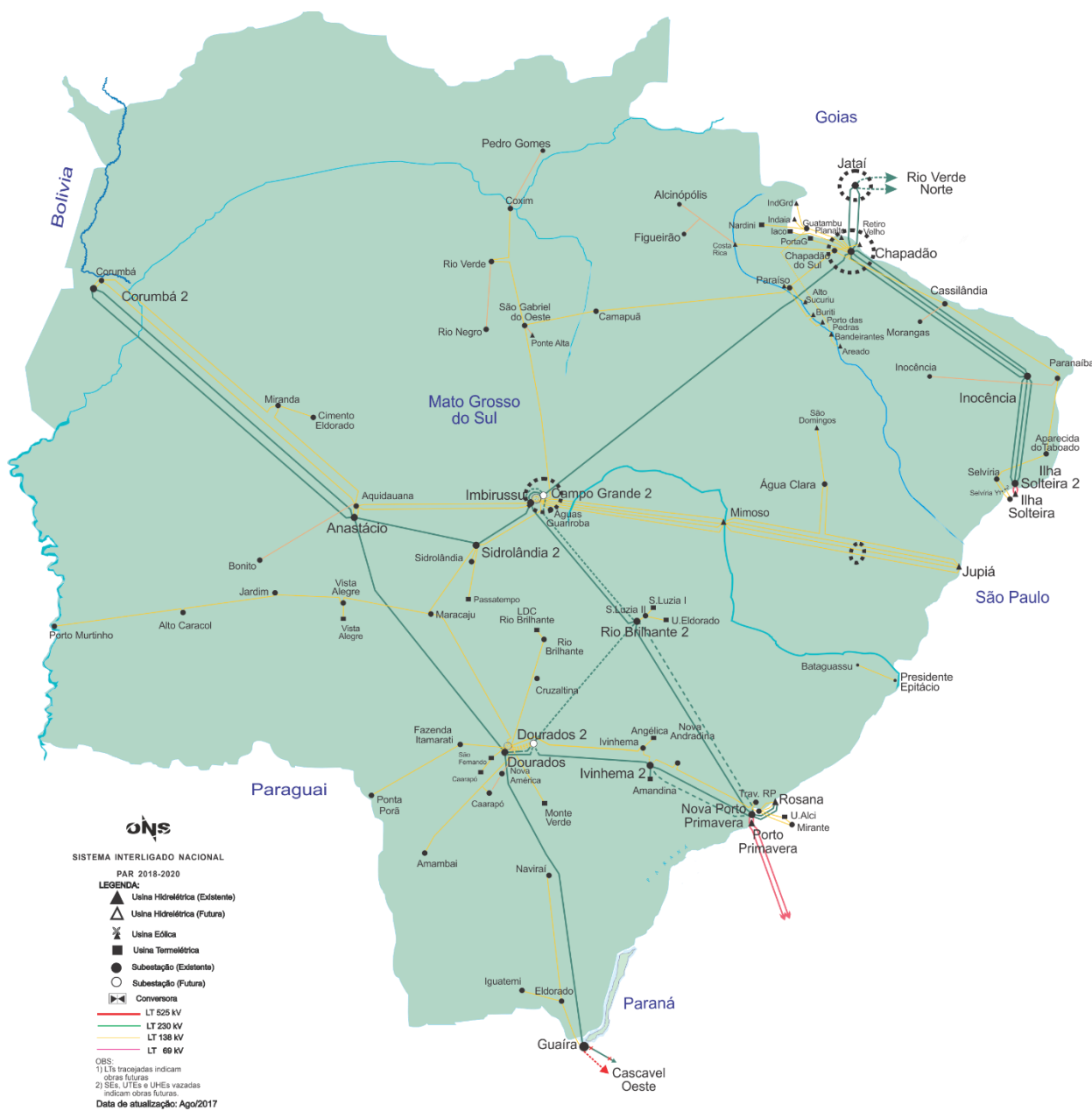
Figura 8-4: Sistema elétrico do Mato Grosso do Sul
