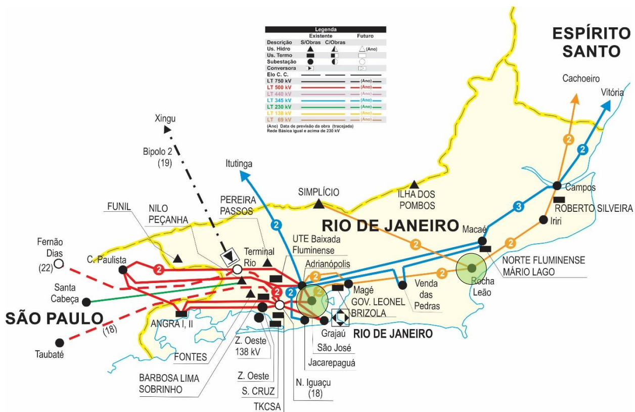
Figura 8-7: Sistema elétrico no estado do Rio de Janeiro
