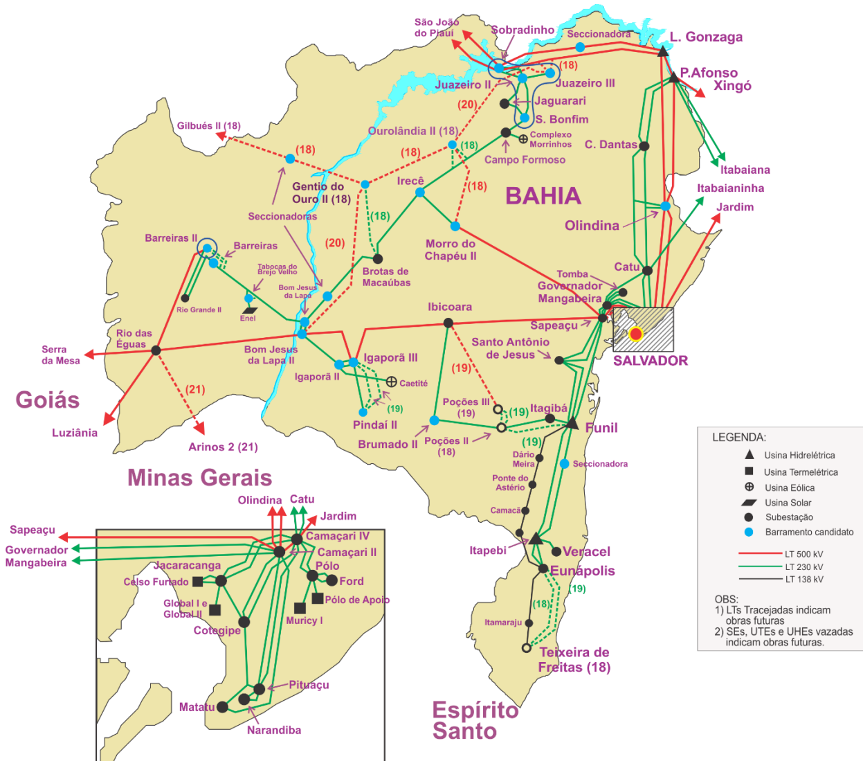
Figura 8-11: Sistema elétrico do estado da Bahia
