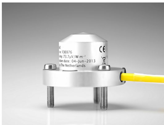
Figura 22. Piranômetro de fotodiodo de silício. Fonte: Kipp&Zonen (2016).
